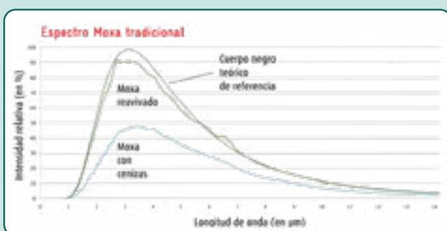
Una artemisa en combustión tiene un espectro de emisión muy extendido, cuyas longitudes de onda van del rojo (en el espectro visible) a los infrarrojos cortos, con un pico situado en los infrarrojos intermedios, y una fuerte proporción de infrarrojos largos. Si se activa la combustión, soplando sobre la misma, por ejemplo, la temperatura de la artemisa sube a 850-900°C, el pico del espectro se sitúa alrededor de 2,6µm, y la proporción de infrarrojos cortos e intermedios es importante.
